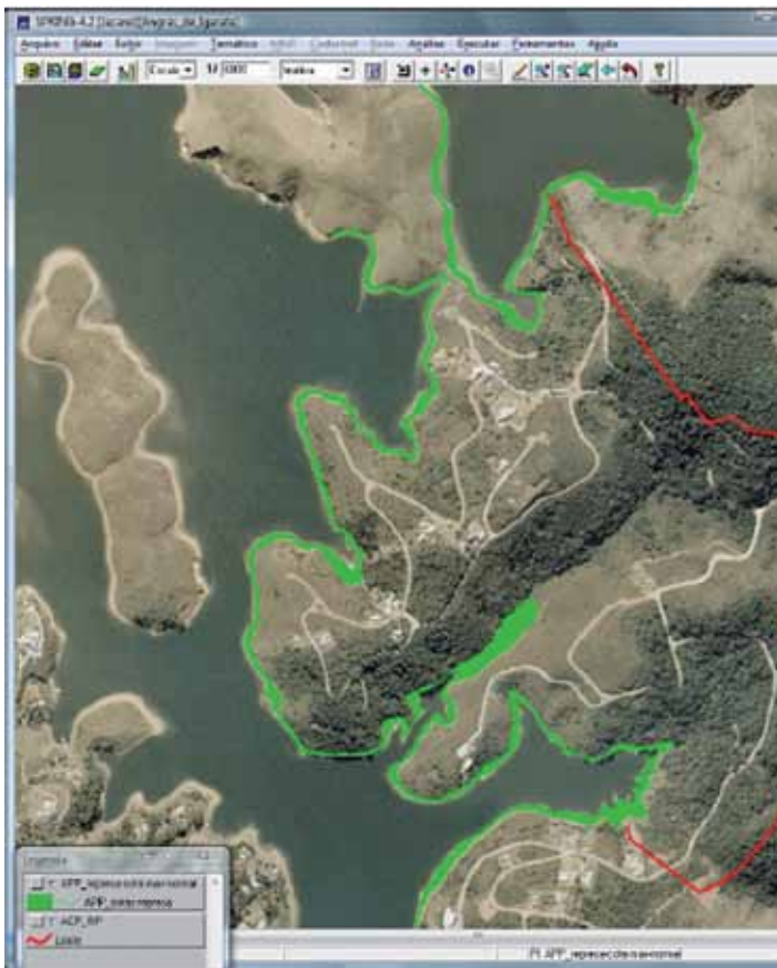
Ortofoto de 2007 da EMPLASA com a APP no entorno do reservatório com a área aproximadamente 7,39ha correspondente a faixa entre as cotas máxima operacional de 623 metros e a cota máxima maximorum de 625,80 metros.
